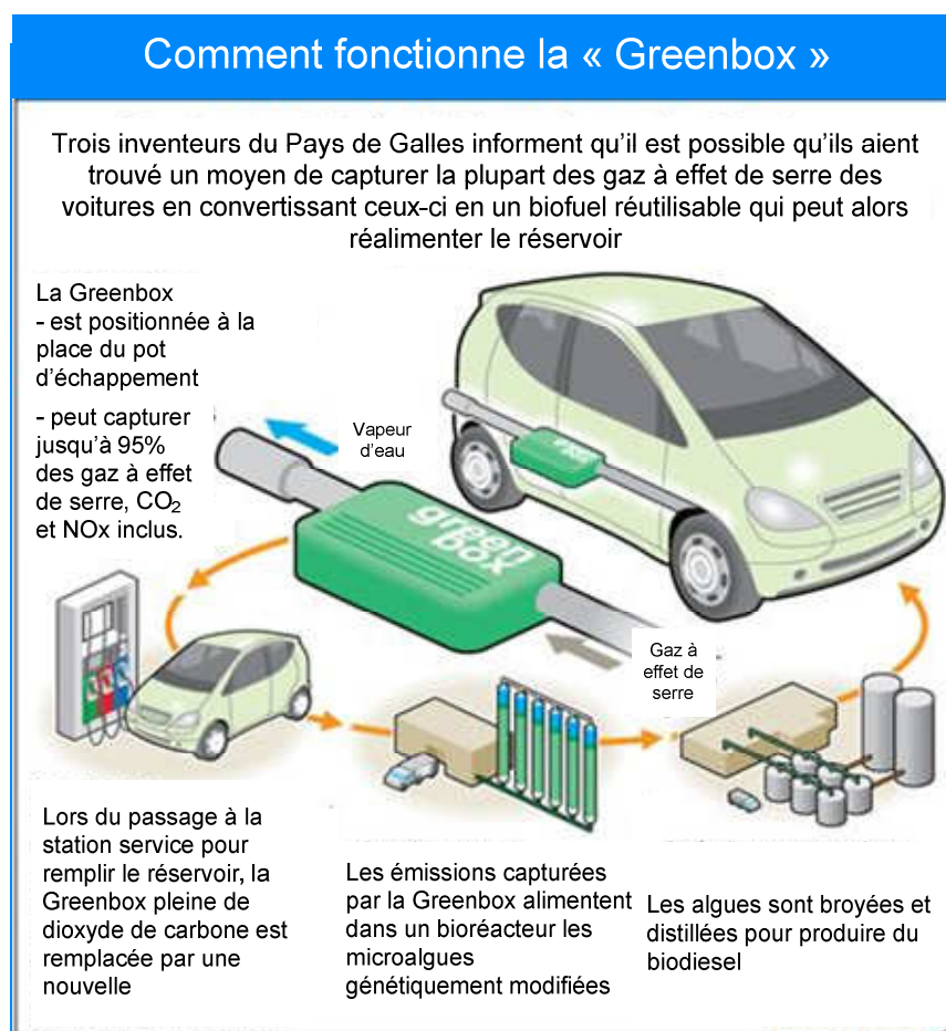
Figure 1.6 : Principe de la « Greenbox » (d'après www.checkbiotech.org )
