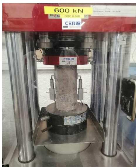
Figure 3.14 – Dispositif de mesure du module d'élasticité
