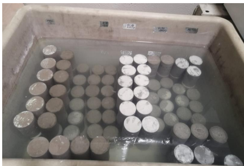
Figure 3.9 – Conservation des éprouvettes en cure humide, eau à « pH basique » à 23 °C
