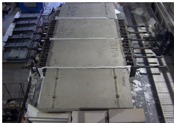
Figure 6.4 – Implantation des dalles sur le four. Etanchéité assurée par de laine minérale
