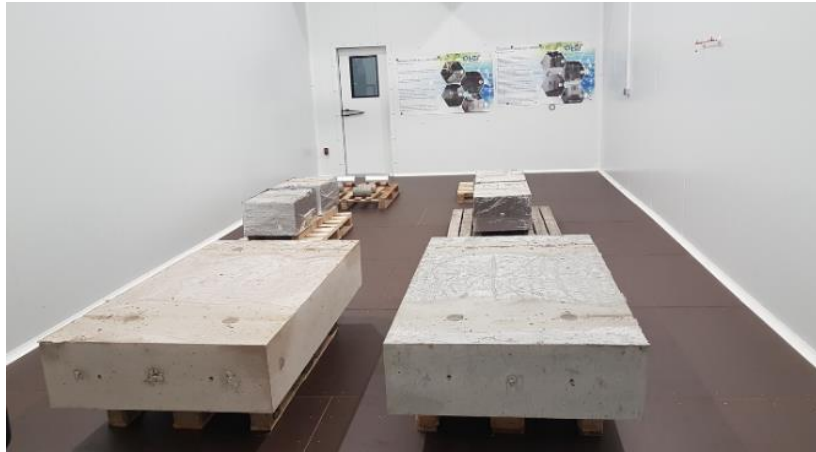
Figure 6.13 – Séchage à 40 °C \pm 2 °C, 65 %HR \pm 5 %HR dans une enceinte climatique 10 m 3 à Ater Métrologie
