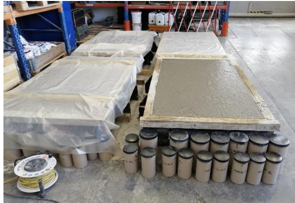
Figure 6.2 – Coulage des dalles et des éprouvettes représentatives
