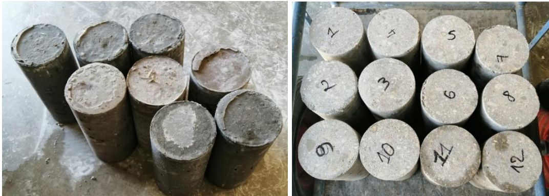
Figure 3.10 – Rectification des surface libres des échantillons
