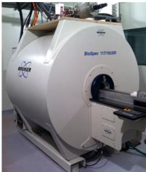
Figure V-1 : IRM préclinique 11,7 T utilisé au cours de cette thèse
