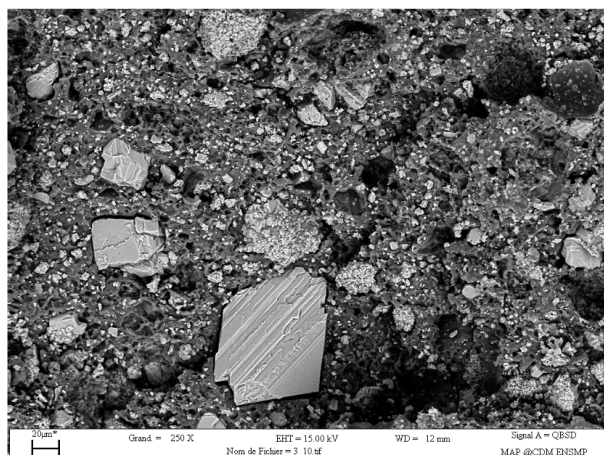
Figure V.6 – Observation par microscopie électronique à balayage (image par électrons rétrodiffusés afin de travailler en contraste chimique) de la microstructure de la colle polyuréthane
