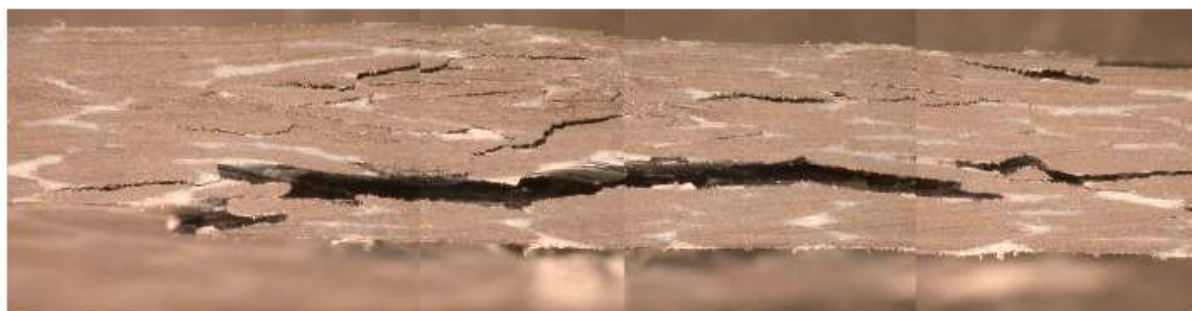
Figure IV.10 – Observations par microscopie optique de la tranche d'une éprouvette ayant subi un essai sur banc de torsion (présence de fissures délamifiantes)
