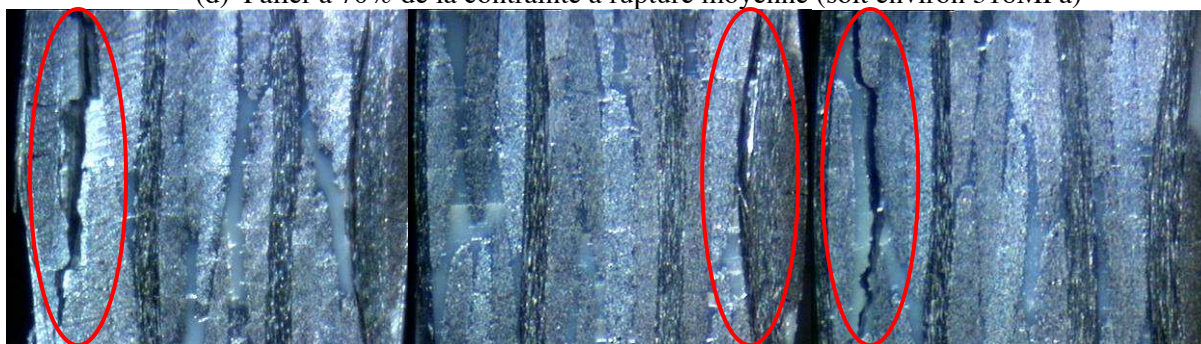
(e) Palier à 90% de la contrainte à rupture moyenne (soit environ 410MPa)
