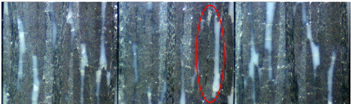
(d) Palier à 80% de la contrainte à rupture moyenne (soit environ 421MPa)
