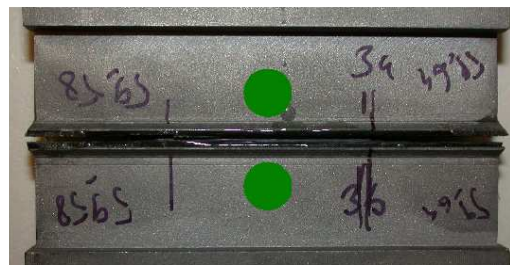
Figure V.24 – Position des capteurs piézoélectriques (cercles verts) sur éprouvette hybride et collée
