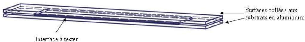
Figure V.3 – Plan des éprouvettes rectifiées pour essais Arcan-Mines sur composite tissé satin 5 de carbone/PPS
