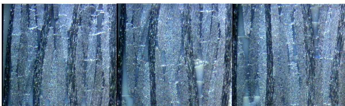
(c) Palier à 60% de la contrainte à rupture moyenne (soit environ 227MPa)
