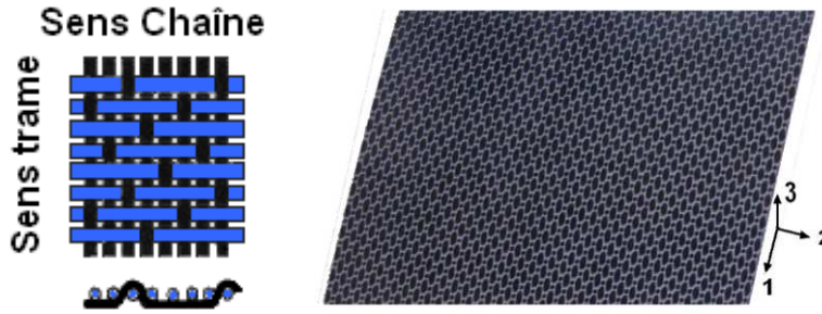
Figure III.1 – Illustration du tissu de type satin 5 et repère global associé au matériau composite
