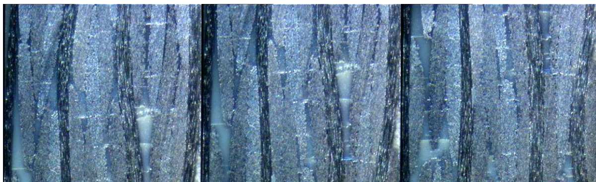
(b) Palier à 10% de la contrainte à rupture moyenne (soit environ 45MPa)
