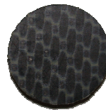
Figure III.10 – Eprouvette de compression de 18mm de diamètre (échelle 1/4)
