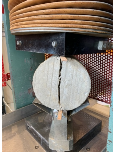
Figure 33. Destruction par fendage de l'éprouvette
