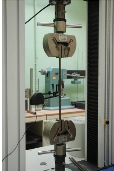
Figure 34. Montage de la barre équipée de l'extensomètre sur la machine de traction, réf. (Jourdain, Molinaro, & Soleilhet, 2018)
