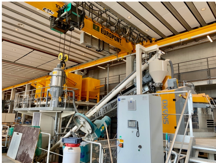
Figure 28. Centrale à béton du Département d'Enseignement et de Recherche Génie Civil Environnement de l'ENS Paris-Saclay: de g. à d. les trémies pour les matériaux, le malaxeur
