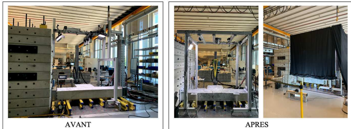
Figure 55. Dispositif testé ESSAI 0 (AVANT) et dispositif corrigé (APRES)
