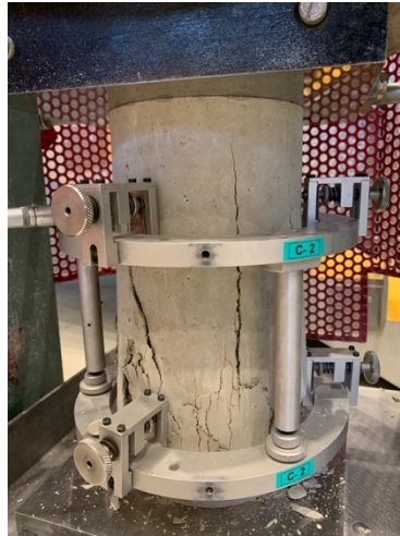
Figure 29. Destruction par compression de l'éprouvette
