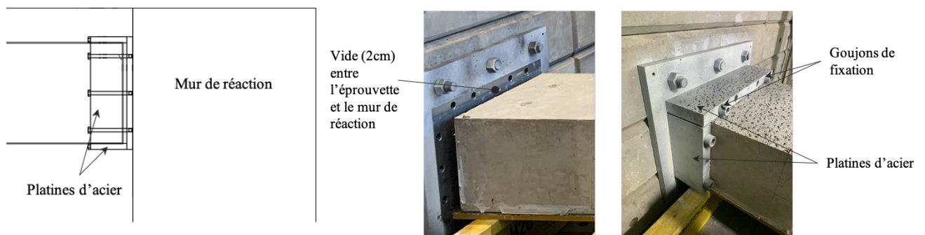
Figure 38. Blocage 2 : condition au niveau du mur de réaction
