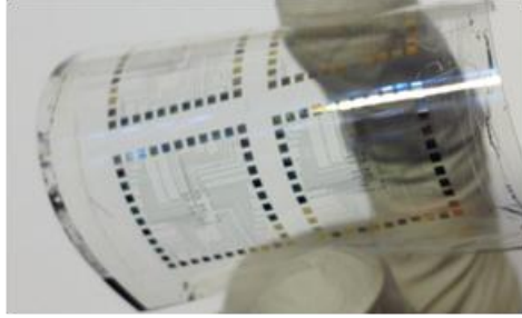
Figure5.1 : OTFT à base de \text{IF}(\text{CN}_2)_2 meta sur substrat PEN
