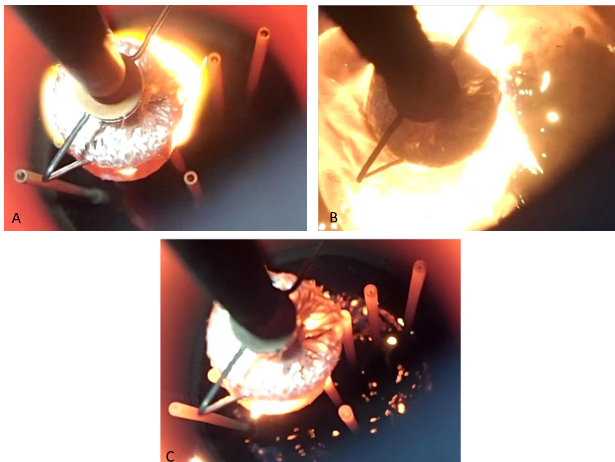
Figure 186 : Images de la combustion de 25g de PE dans un sac en fibre de verre avec une température de four de 840°C A : 10s après le début de l'inflammation – B : durant la combustion – C : lors de l'extinction de la flamme
