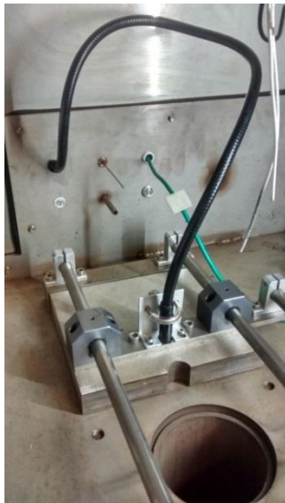
Figure 208 : Endoscope A : bloc coulissant ouvert, B : Bloc coulissant fermé lors d'une mesure
