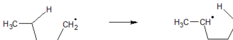
Figure 36 : Exemple de transfert d'hydrogène 1,4
