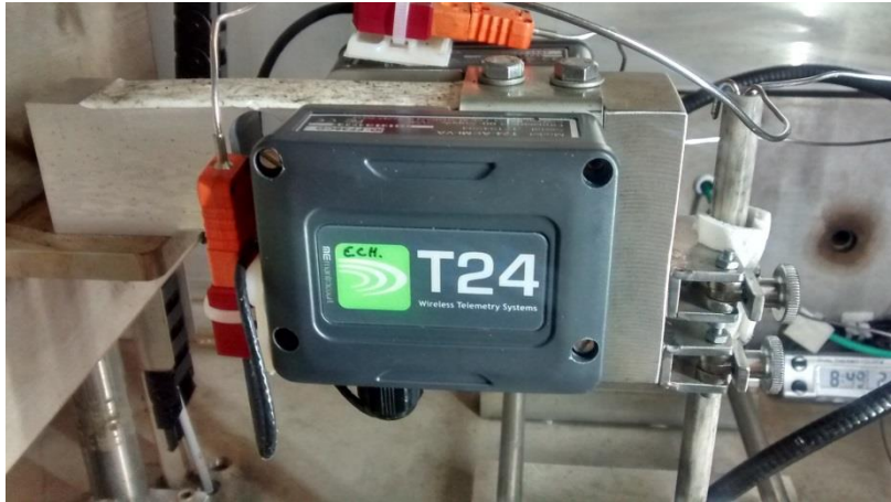
Figure 209 : Transpondeurs fixés sur le peson
