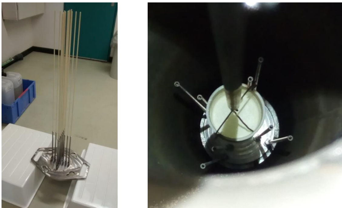
Figure 72 : Dispositif de mesure de températures des gaz à l'intérieur du four
