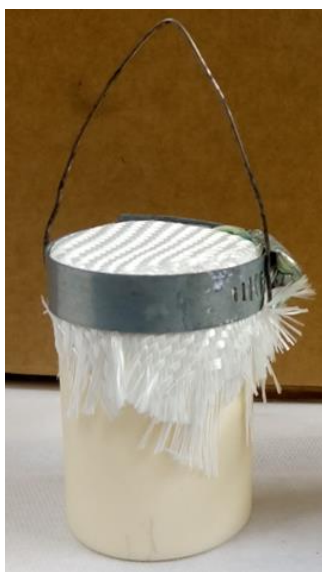
Figure 190 : Creuset fermé par un tissu en fibre de verre
