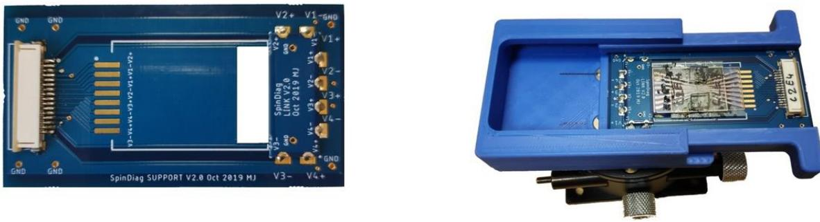
**Fig. 2.6 - A gauche, le nouveau PCB et à droite, le PCB sur son support coulissant imprimé en 3D**
