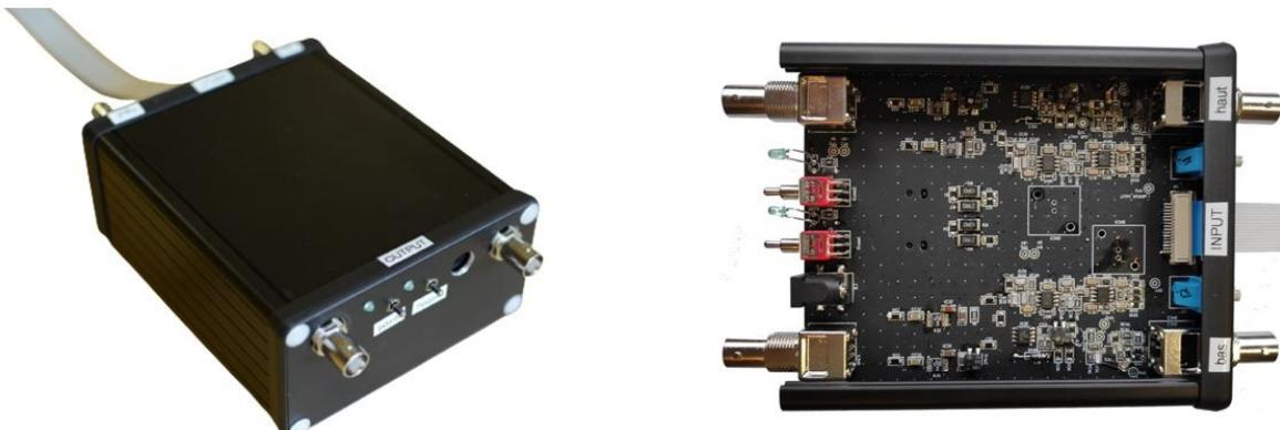
**Fig. 2.9 - Boîtier électronique pour la biopuce GMR à deux étages**
