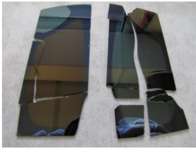
Figure 5-41. (a)(c)(d) Photographies et (b) images SAM des échantillons de mesure d'énergie pour le collage \alpha\text{-SiOCH}_3/\text{Si} (300 nm et k = 2,5 ) recuit à 900^\circ\text{C} selon le largueur de la barrette (a)(b) 3, 5 et 10 mm (c) 40 mm ; et (d) d'un collage \alpha\text{-SiOCH}_3/\text{Si} (300 nm et k = 2,25 ) pleine plaque de diamètre 200 mm.
