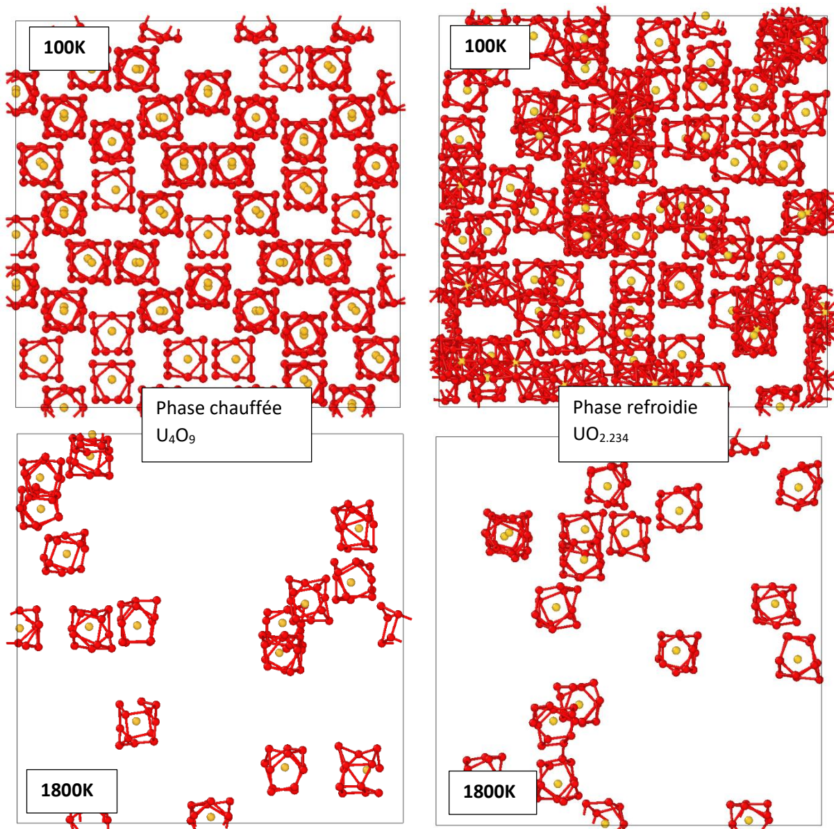
Figure 2.27 : Représentation des agrégats (COT et COT multiples) détectés dans les systèmes chauffés et refroidis pour deux températures, une élevée et une basse. Seuls ces agrégats sont représentés et les centres des COT sont mis en évidence en jaune. Ces images sont tirées à des moments aléatoires lors de la DM à température constante.
