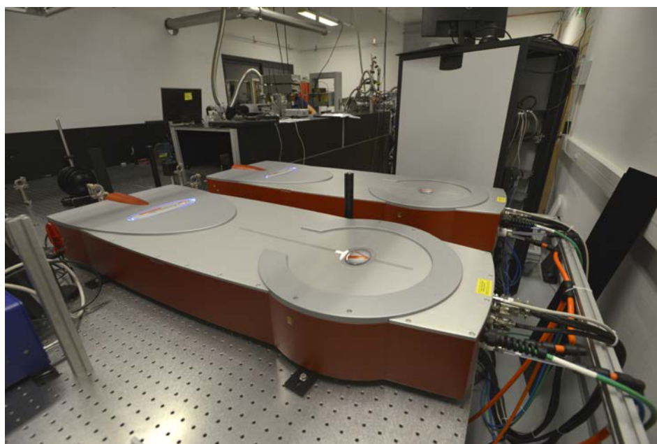
FIGURE 1.1 – Image du système BlastBeat - deux laser fibrés à ytterbium partageant le même oscillateur, soit quasi-synchronisés. Les deux modules d'amplification et l'oscillateur fibré sont contenus dans la baie verticale en arrière plan.
