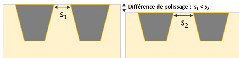
FIGURE 3.34 – Variation de l'espacement inter-lignes résultant d'un sur-polissage lors de l'étape de CMP.
