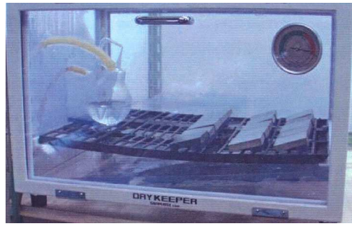
Figure 15. Essai de colonisation de matériaux de construction par brumisation (DUBOSC 2000).
