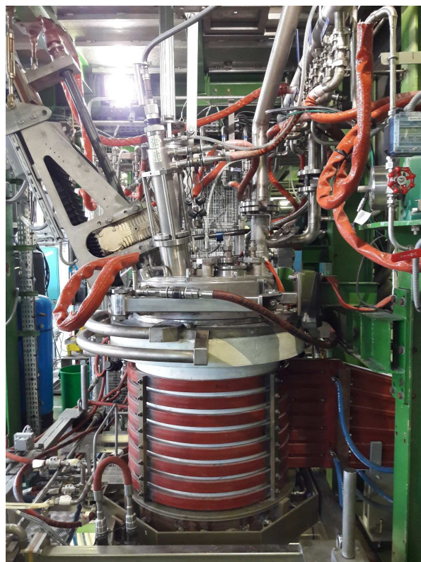
(a) Photographie d'un creuset froid instrumenté en fonctionnement au CEA
