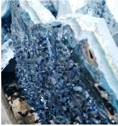
(a) Photographie de la couche résistive au contact de la virole du creuset froid après refroidissement
