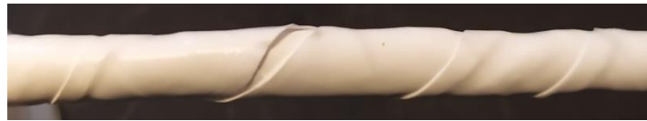
Fig. 4-19. Photographie des écarts et superpositions observés sur le paquet de fibres.
