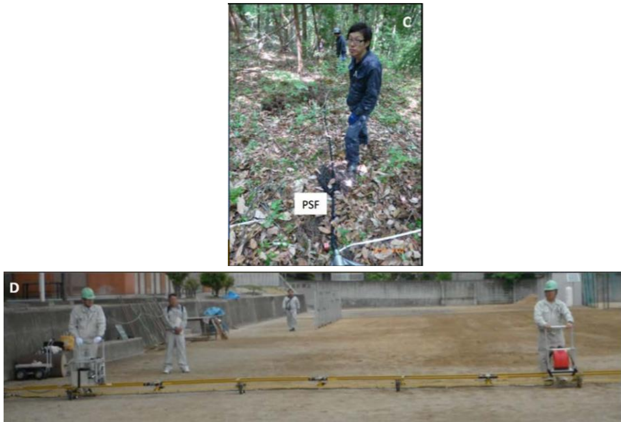
Fig. 2-33. Photographies de détecteurs basés sur des fibres scintillantes utilisés pour la caractérisation radiologique de forêts (en haut) et sols urbains (en bas) [50].
