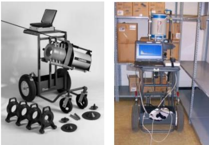
Fig. 2-8. Spectromètre gamma HPGe avec système ISOCS (à gauche), et exemple d'utilisation sur site (à droite) [14].
