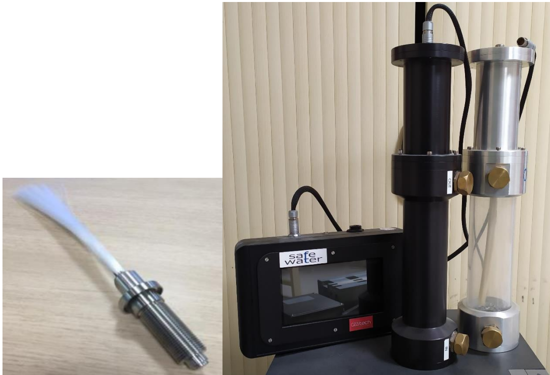
Fig. 2-35. Détecteur du dispositif SAFEWATER à gauche, et système intégré à droite [53].
