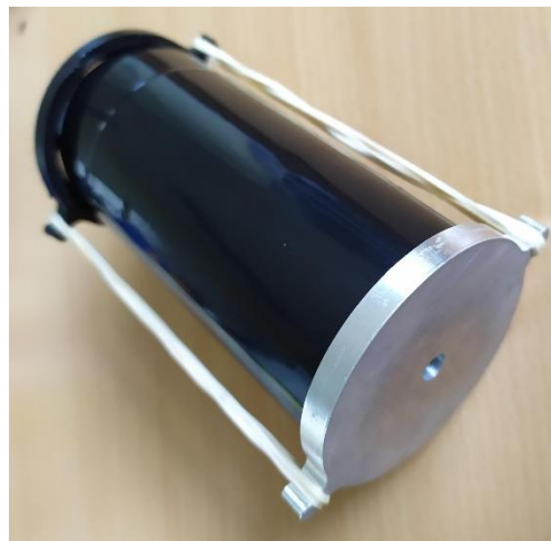
Fig. 3-14. Montage du support pour paquet de fibres sur un PMT, sans embase. La pièce en aluminium est visible au premier plan et la pièce en plastique est à l'arrière du PMT, de couleur noire. Des élastiques sont tendus entre les deux pièces à l'aide des éperons.
