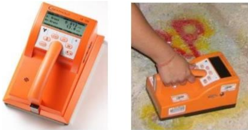
Fig. 2-7. Contaminamètre employé de type Berthold LB124 SCINT (à gauche), et exemple d'utilisation sur site (à droite) [14].
