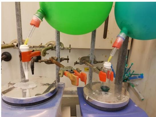
Figure 27 : A gauche, la suspension du sel dans le THF. A droite, la solution du catalyseur et la base dans le THF.
