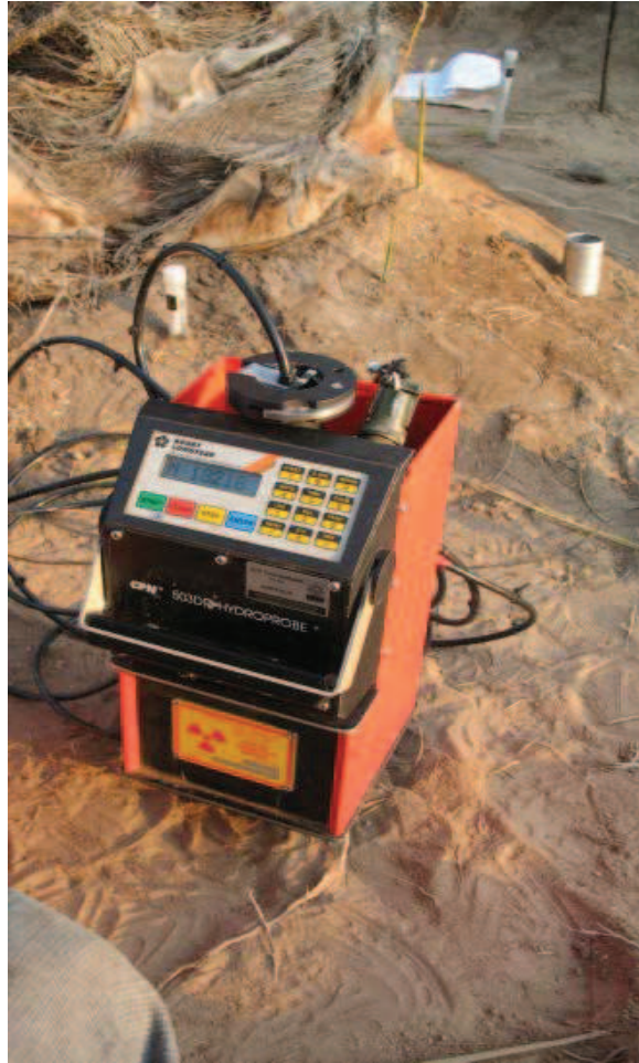
Photo 3.6 : Sonde à neutrons Campbell Pacific Nuclear (CPN®), 503 DR Hydroprobe.
