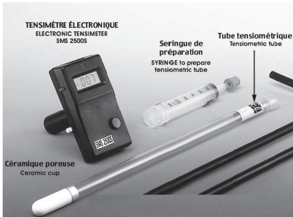
Photo 3.7 : Tensiomètres avec bougie poreuse et tensimètre électronique SMS 2500S de SDEC France.
