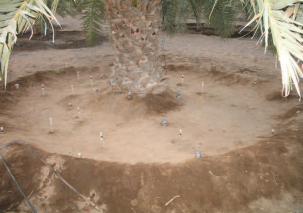
Photo 3.8 : Le dispositif expérimental (tubes d'accès de la sonde à neutrons et tensiomètres) installé dans la cuvette du palmier dattier étudié.
