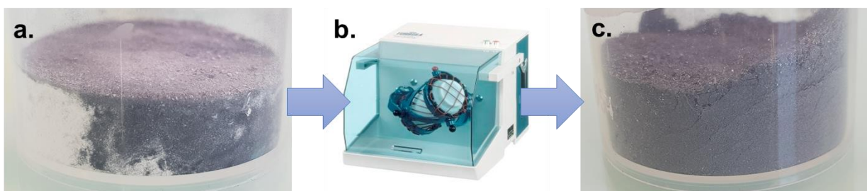
Figure 66 – Poudre de LLZO (blanche) + poudre de LCO (noire) avant agitation (a.), après agitation (c.) à l'aide du Turbula (b.)
