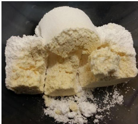
Image 1 - Poudre extraite du creuset après l'unique calcination à 1125°C pendant 6h
