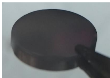
Image 13 - Pastille composite (LLZO + matériau actif) pressée à froid
