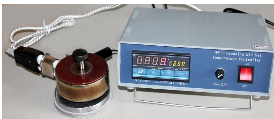
Image 7 - Moule chauffant utilisé pour l'assemblage des cellules symétriques
