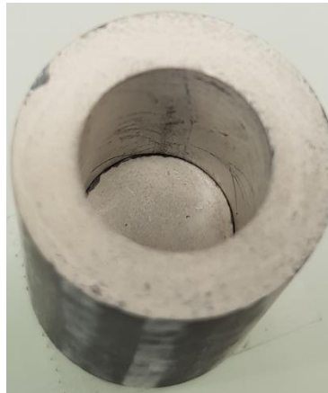
Image 15 – Cylindre en graphite pour CUC après dépôt d'un revêtement en nitrure de bore
