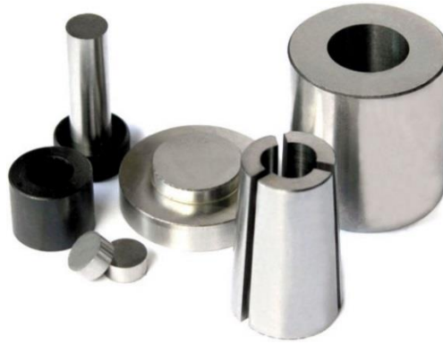
Image 4 - Moule trapézoïdale en 3 parties utilisé pour compacter la poudre de LLZO
