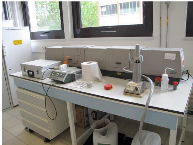
Image 22 - Photographie du granulomètre LASER Malvern (Mastersizer S modèle MSS).
