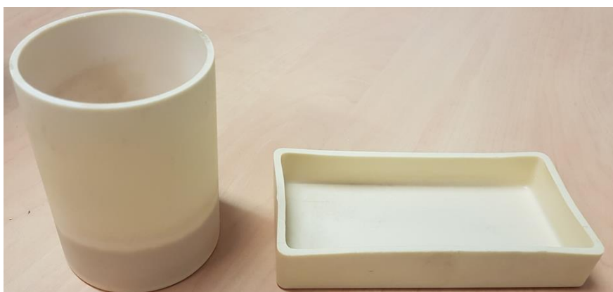
Image 3 - Creuset cylindre en MgO à gauche, creuset plat en MgO à droite
