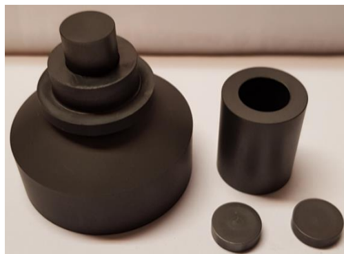
Image 6 – Différents éléments de la matrice graphite utilisée pour la technique de CUC
