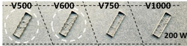
Figure IV. 45 : Mur SLM pour 200 W pour 4 vitesses (a) D150 (b) D70. Les murs fabriqués à D150 (défocalisé) ont un VED 4 fois plus faible et ne présentent pas de humping (en rouge).
