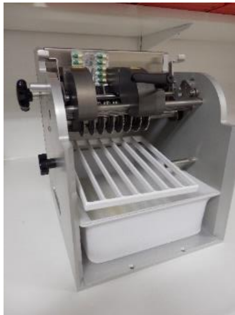
Figure 42 : Exemple de machine à déblistérer (photo prise dans une pharmacie de Normandie)
