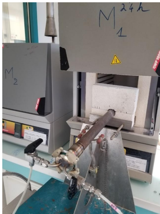
Figure 110 : photo du système de traitement thermique utilisant un demi-tube FeCrAl
