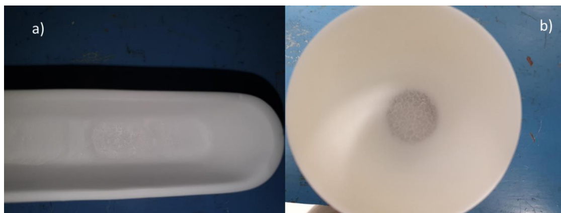
Figure 112 : photo d'un creuset abimé par la corrosion du fluor a) de type bateau b) type classique
