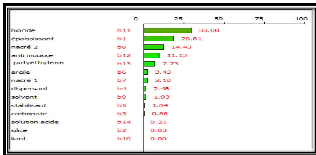
Figure 16 : diagramme de Pareto pour viscosité ( 1/10\text{mm}/5^{\circ} )
