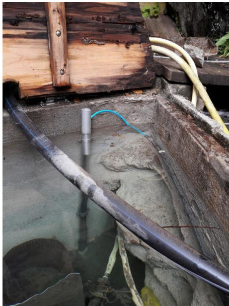
Figure 57: Sonde de pression dans le tube de protection
