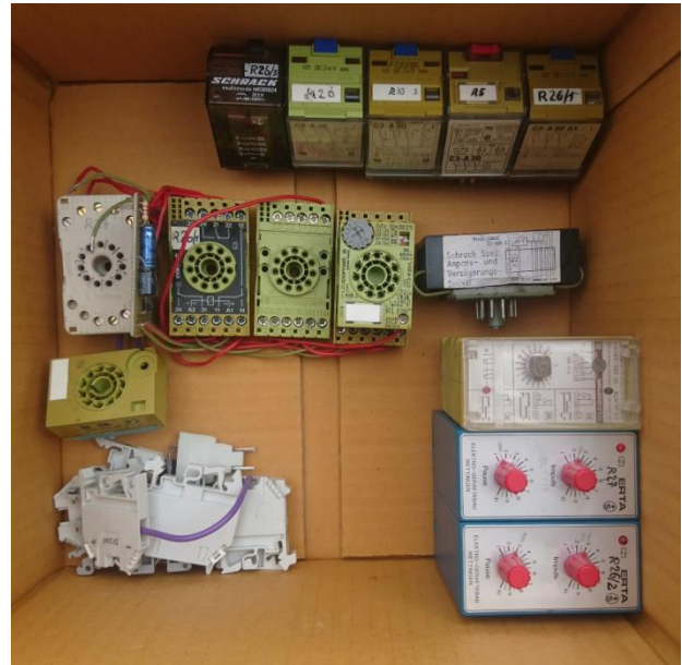
Figure 60: Composants démontés et remplacés par l'automate
