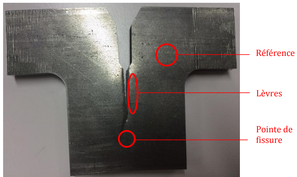
Figure 16 : Localisation des tests de dureté
