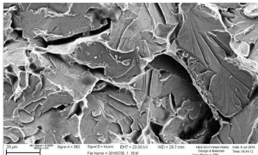
Figure 40 : Faciès de rupture au milieu de la fissure (Grossissement fort)
