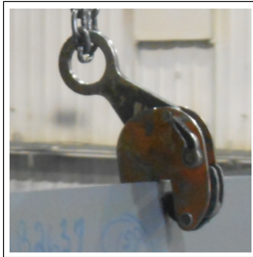
Figure 5.7 Exemple de pince serrant un membre
