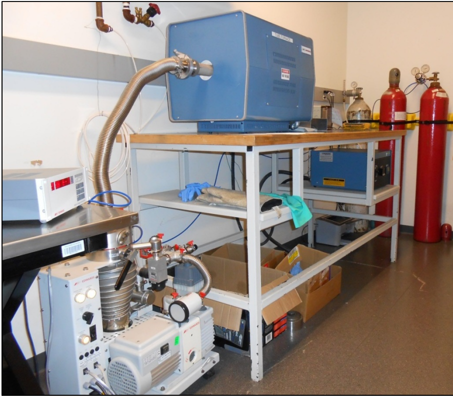
Figure 2.10 Four de brasage utilisé avec la pompe à vide branchée sur l'extrémité gauche
