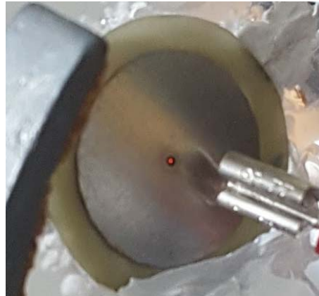
Figure 35 : Test de génération de plasma dans un PCB bouché
