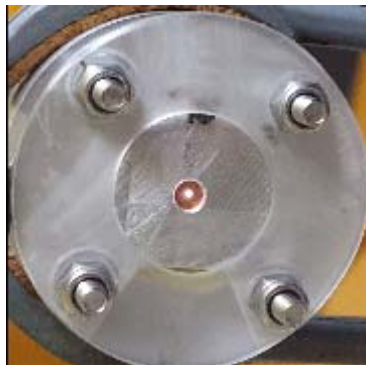
Figure 42 : Plasma constant obtenu dans le trou avec flux d'argon
