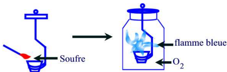
Figure 1 : Combustion du soufre dans le dioxygène
