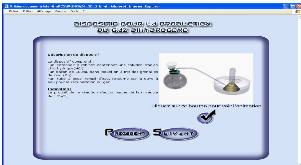
Figure 52 : Phase de la production du dihydrogène
