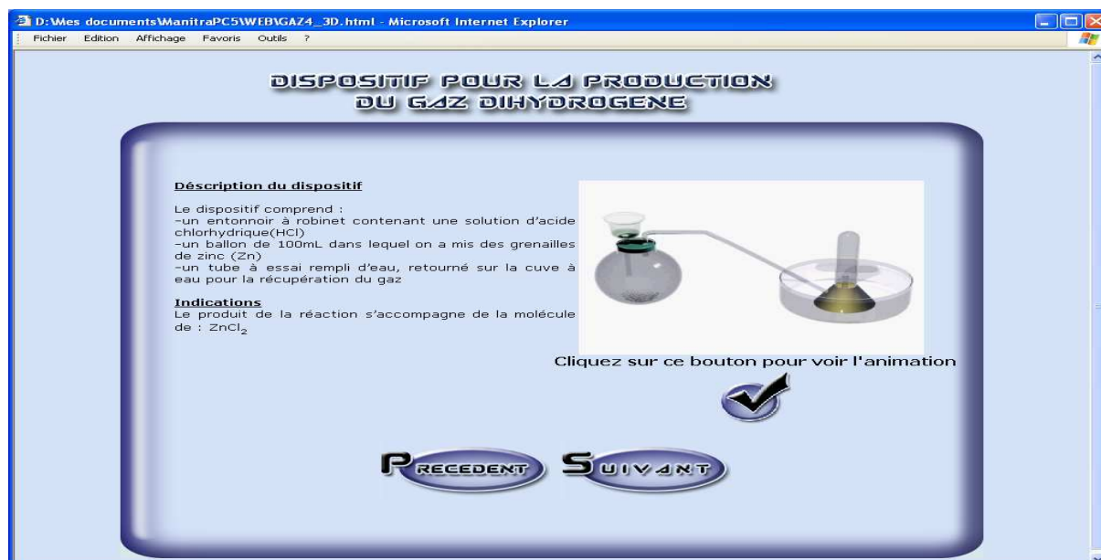
Figure 51 : Présentation du dispositif de production du dihydrogène
