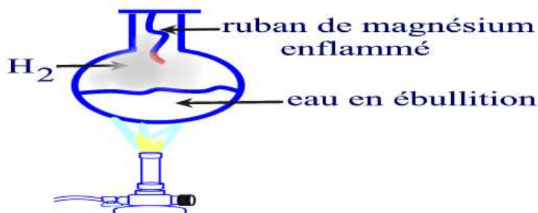
Figure 14 : Réduction de l'eau par le magnésium
