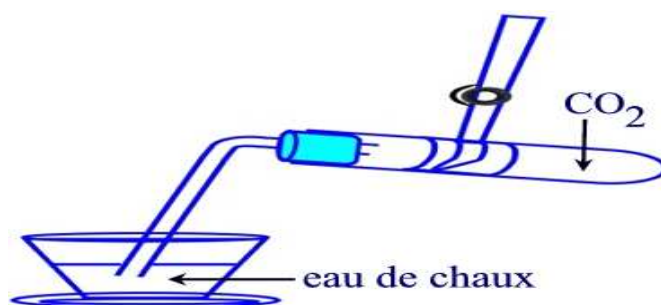
Figure 63 : Montage pour le test du gaz \text{CO}_2
