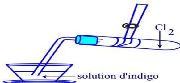
Figure 59 : Montage pour le test du gaz \text{Cl}_2
