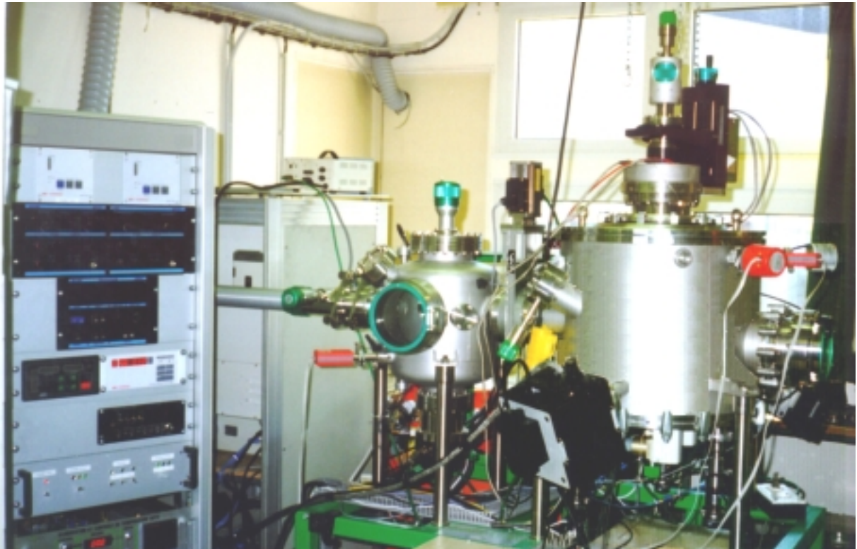
figure III-1 : Bâti de pulvérisation cathodique servant à l'élaboration des couches minces de silice enrichie en silicium.
