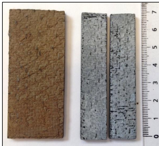
Figure IV. 16 : À gauche, éprouvette imprégnée par APS et à droite, l'éprouvette découpée en deux barreaux de tailles égales après la réaction SHS pour le test de traction
