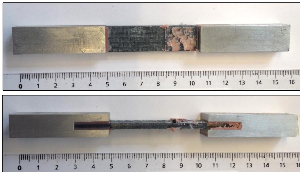
Figure IV. 20 : Décollement de l'éprouvette dans le talon durant l'essai de traction
