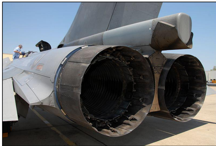
Figure I. 21 : Moteurs M88 du rafale, équipés de ses volets en \text{C}/\text{SiC}
