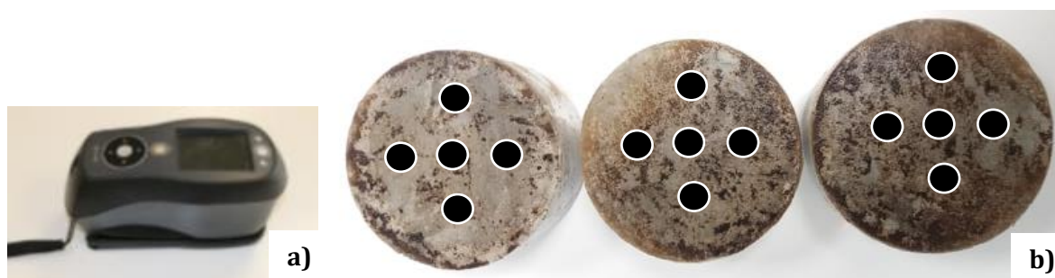
Figure 32. Spectrophotomètre utilisé (Ci60 (X-Rite)) (a) ; disposition de l'emplacement des mesures au spectromètre réalisées (ronds noirs) (b)
