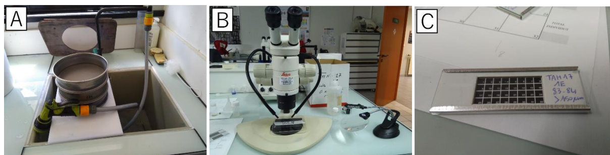
Figure III.14 - A : colonne de tamis (63, 125 et 150 \mu\text{m} ) utilisée dans le lavage du sédiment. B : loupe Binoculaire pour le prélèvement des foraminifères contenus dans le sédiment. C : exemple de cellule de Chapman contenant des foraminifères.
