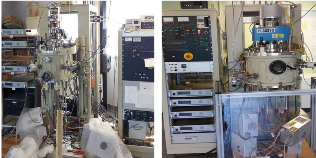
Figure II.4 : Bâti de pulvérisation cathodique RF magnétron multicibles, à gauche pour le dépôt des films de PZT et de Pt, et à droite pour le dépôt des films de Terfenol-D.
