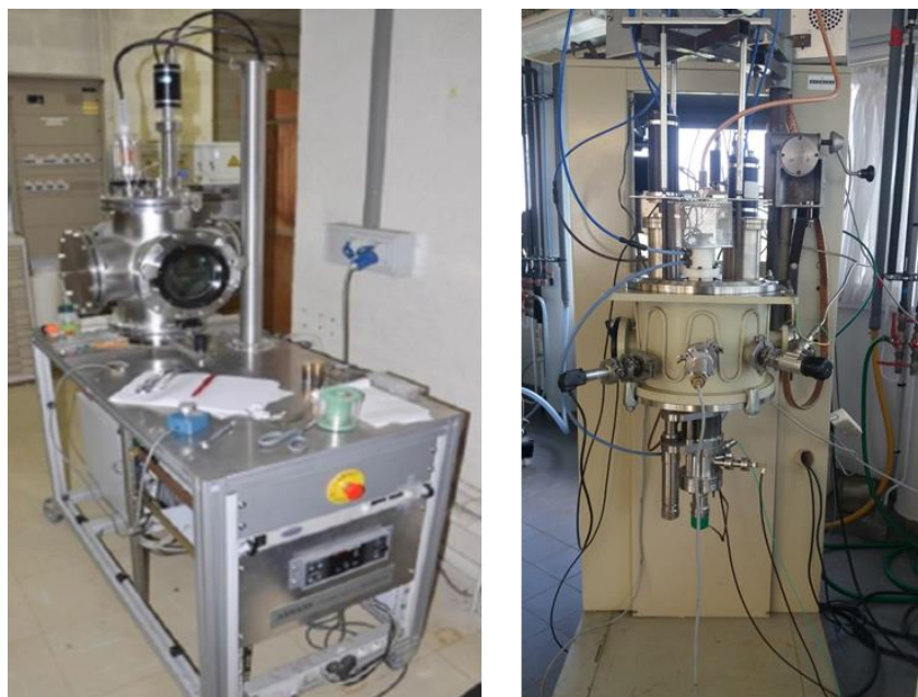
Figure II.5 : Bâtis monocibles de pulvérisation cathodique continue à gauche et de pulvérisation cathodique RF magnétron à droite, utilisés pour le dépôt d'or et de TiN respectivement.
