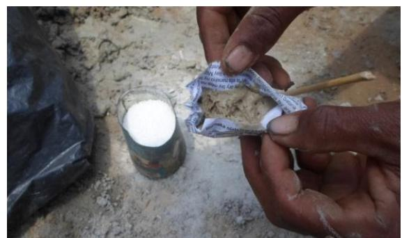
Les Nitrate fuels, ce sont des explosifs en vrac utilisés dans les charges de colonne pour l'abattage de roche tendre et dure en carrière en l'absence d'eau.
