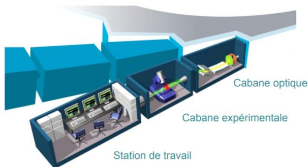
Figure IV-12 : Schéma d'organisation d'une ligne de lumière
