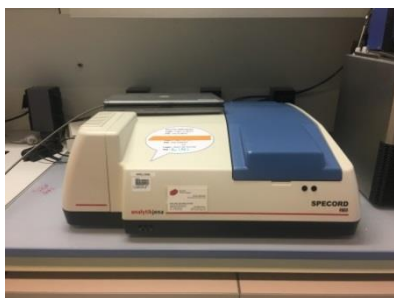
Figure IV-2 : a) Spectrophotomètre Analytik Jena specord® 210 b) Schéma du principe d'un spectrophotomètre double faisceau. Source : Tabouche 110
