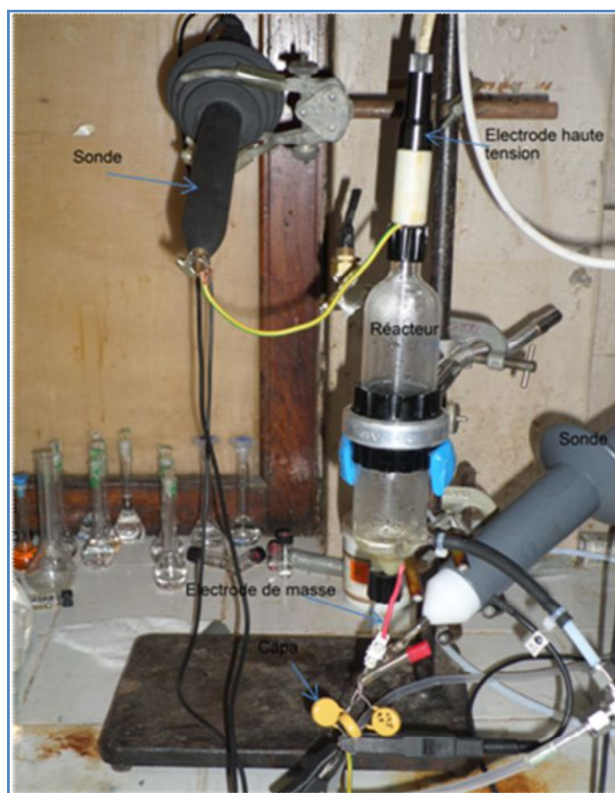
Figure II-19: Réacteur DBD pointe/plan
