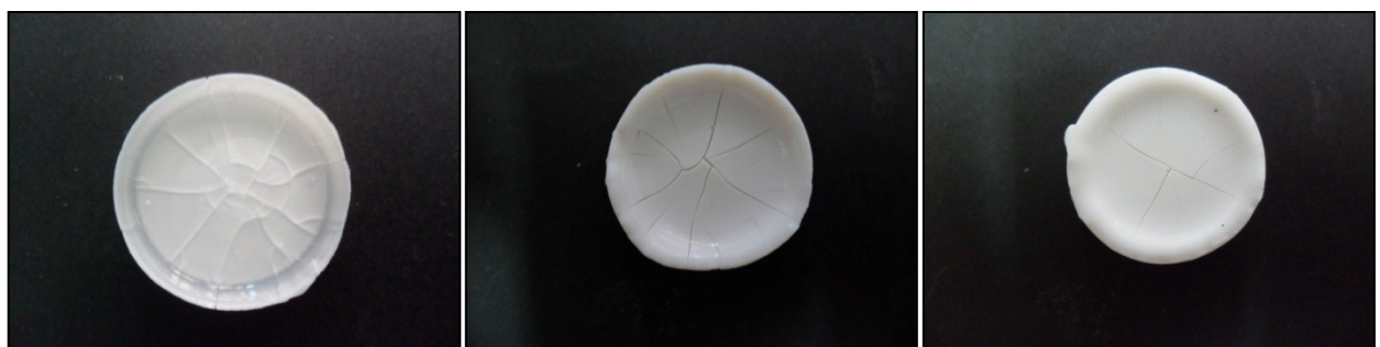
Figure 98 : Fractures dans des corps à cru coulés et séchés sur du gypse respectivement à \alpha_p=10,9\% , 15,93\% et 22,13\% .
