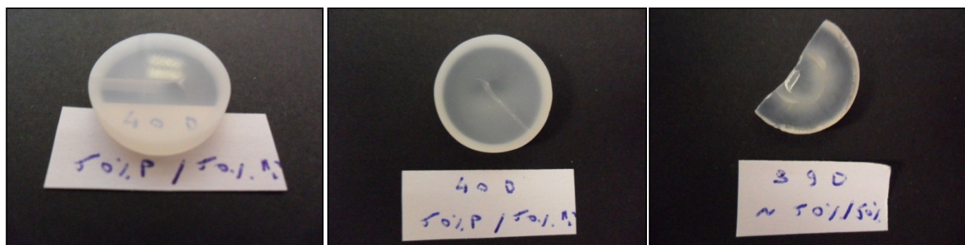
Figure 99 : Céramiques CaF 2 :Yb (5% at.), issues d'une mise en forme par coulage de poudre redispersées, après frittage naturel à 600 °C, pendant 1h (les rapports affichés se réfèrent au rapport de masse H 2 O/poudre dans la dispersion de départ.
