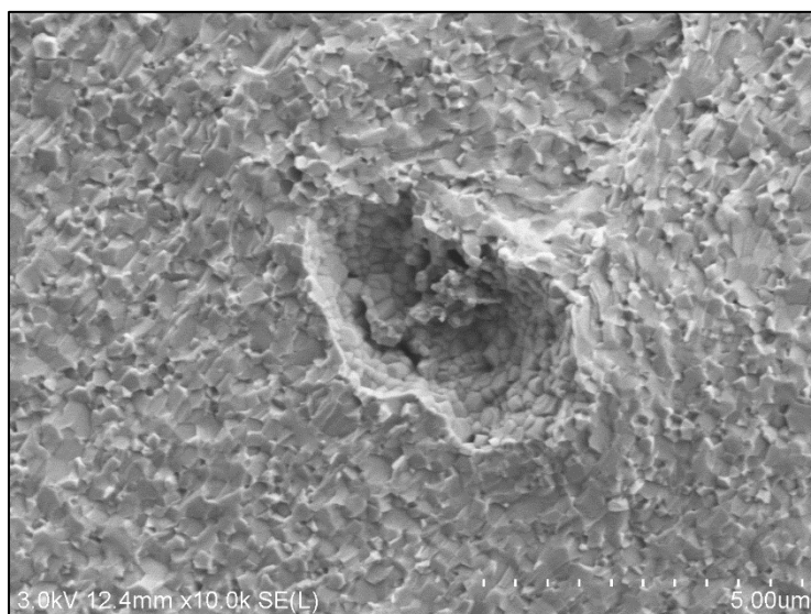
Figure 25 : Porosité large et présentant un granulation de surface, observée sur une photographie MEB-FEG en fracture d'une céramique \text{CaF}_2:\text{Er} (5% at.)
