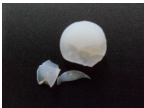
Figure 69 : Céramique \text{CaF}_2\text{:Yb} (5%at.) produite à partir de poudres lyophilisées, translucide à un stade intermédiaire
