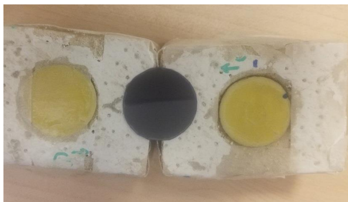
Figure 55. Volume traité représenté par une cible (deux demi-sphères, à gauche et à droite) dans un cube en fibres minérales. Le film EBT 3 (cercle noir au milieu) est inséré dans la cible.
