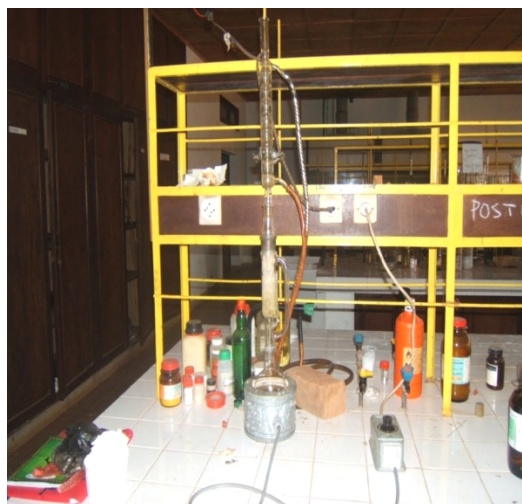
Figure 15 : Appareillage d'extraction d'huile par solvant
