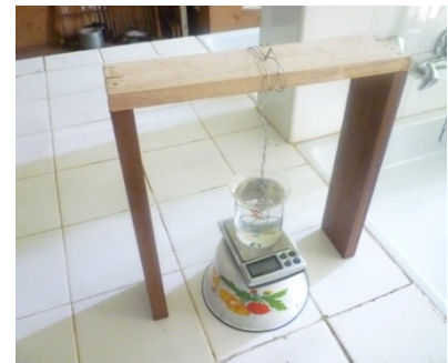
Photo 9 : Dispositif de mesure des volumes (saturés et à 12%)
