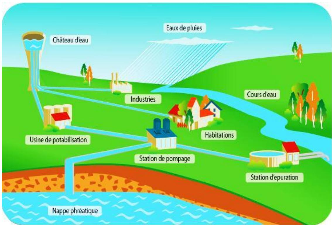
Figure 27 : Réseau d'adduction d'eau potable
