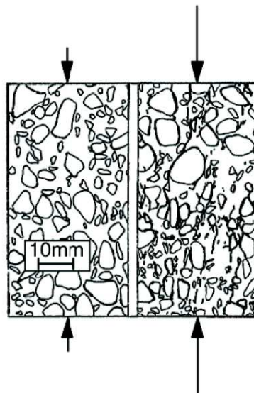
FIGURE 3.3: Évolution de la microfissuration du béton en compression (pétrographie Shah)
