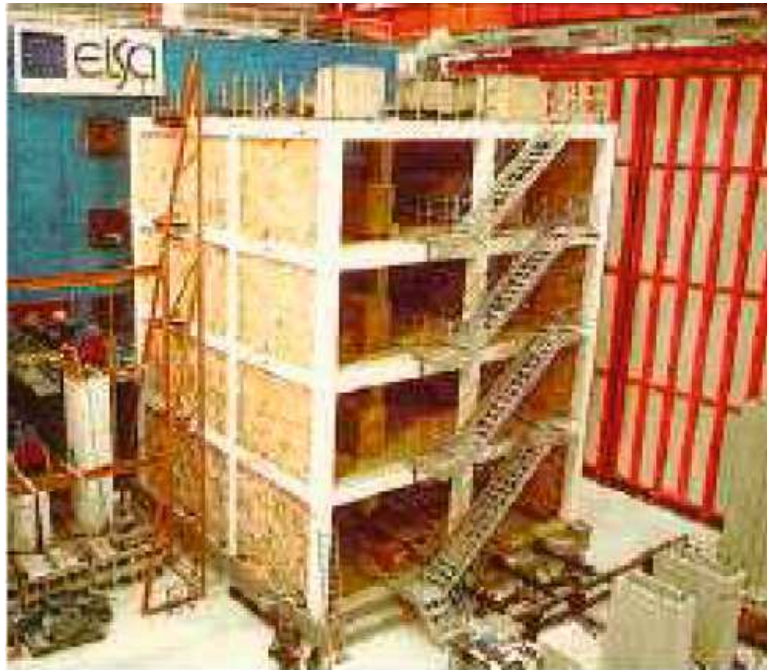
FIGURE 1.4: Exemple de structure testée sur un mur de réaction (ELSA, Ispra) [Sollogoub, 2007]
