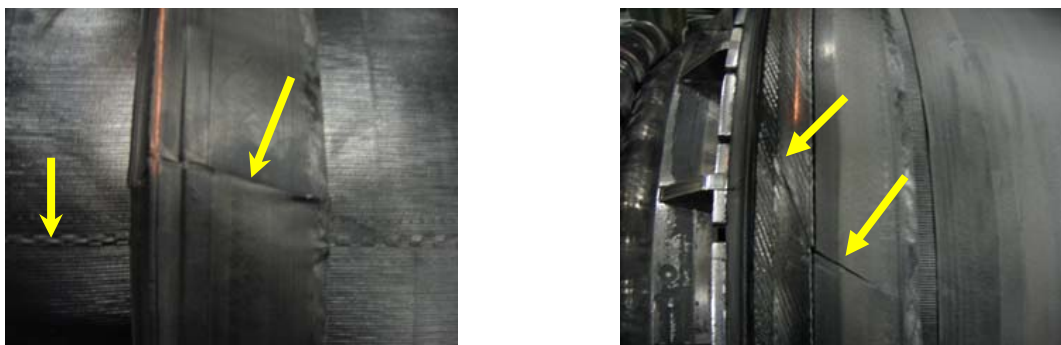
Figure 1-1 : Exemple de soudures sur les bandages.
