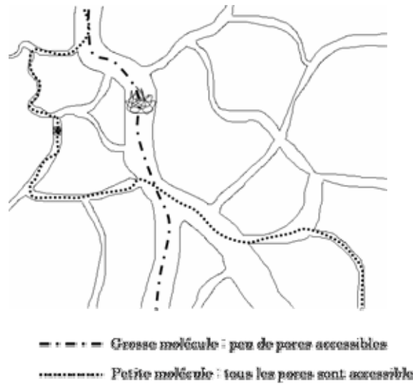
Figure 2-7 : Chemin parcouru à travers une colonne de CES par deux polymères de R_H différents.
