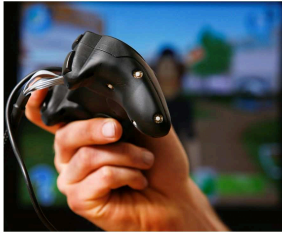
Figure 8 Manette de jeu munie d'interfaces vibrotactiles sur les surfaces de préhension
