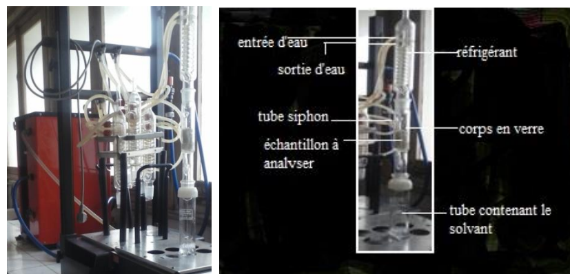
Figure 11: Appareil et montage d'extraction d'huile, le soxhlet
