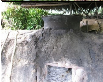
Photo 14 : Alambic pour la production d'huile essentielle de girofle (eugénol)
