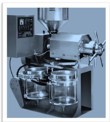
Figure 6 : Presse à vis d'Archimède pour huile
