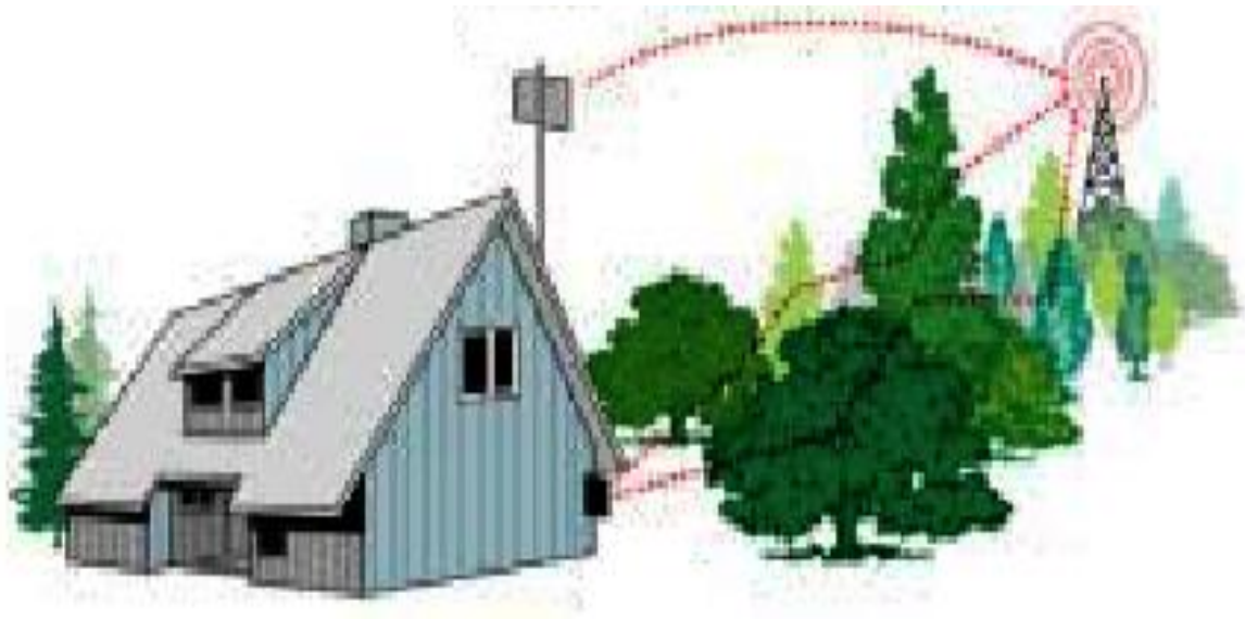
Figure 1.03 : Schéma du principe de Boucle Locale Radio en présence de LOS et NLOS.
