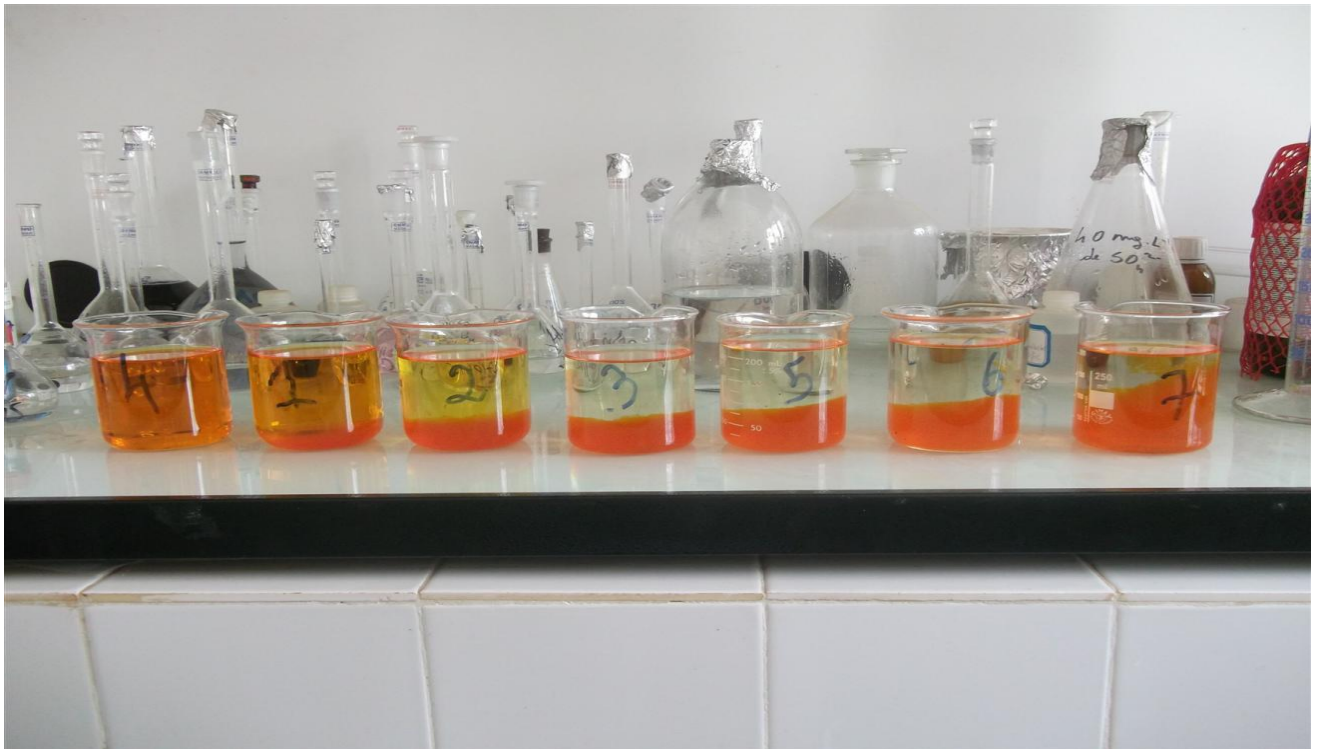
Figure 18 : Décantation apres l'agitation par ordre croissante de quantité de chitosane
