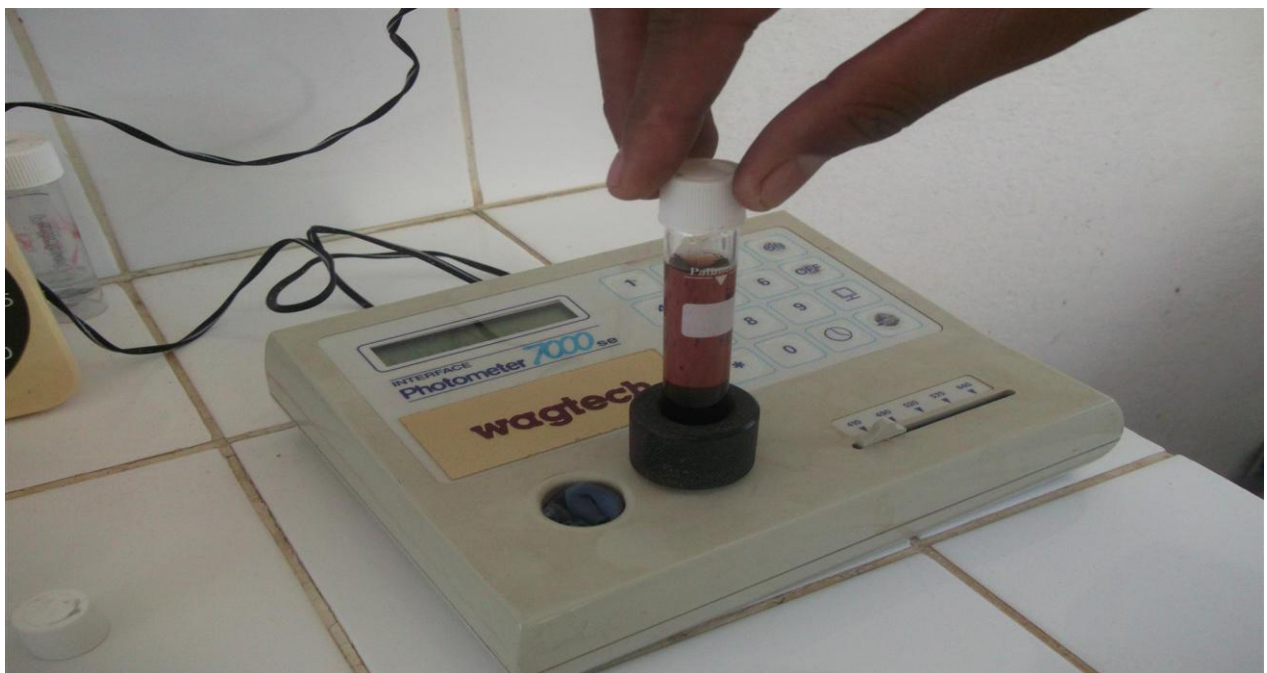
Figure 16 : Mesure avec le palintest photometer 7000 SE
