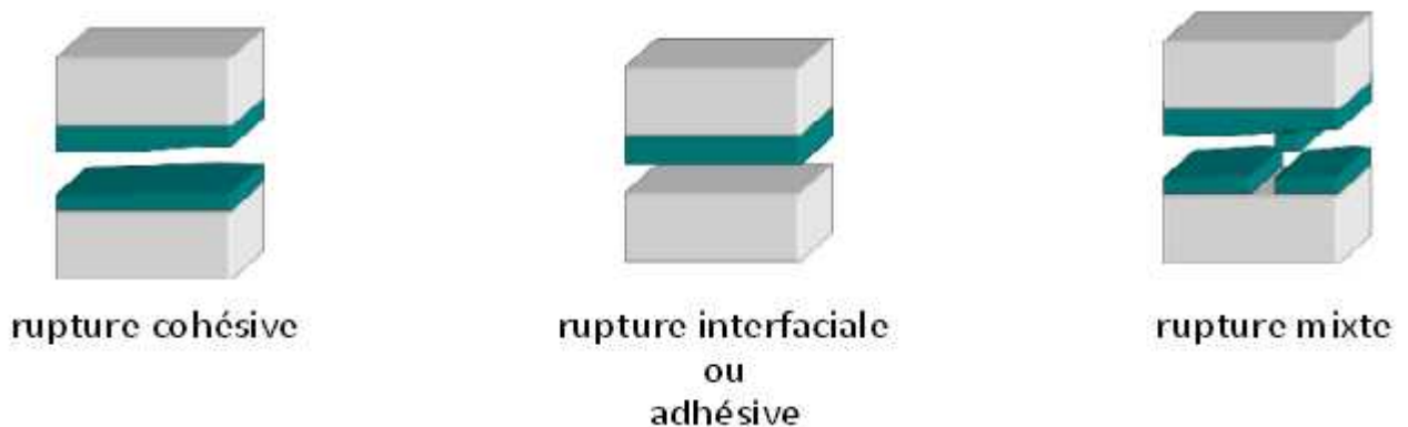
Figure 18 : Rupture cohésive, adhésive et mixte
