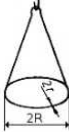
Figure 9 : Schéma de l'anneau de Noüy.
